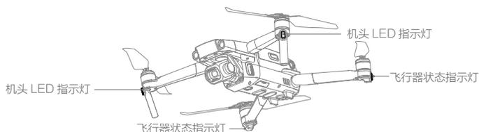
机头 LED 指示灯用于指示飞行器的机头方向，飞行器启动后将显示红灯常亮（可在 DJI GO 4 App 设置关闭）。
