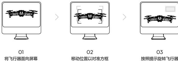
根据提示，重复以上步骤校准后视、下视和侧视视觉系统。
